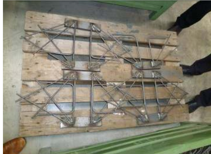
ijzervlechterij Cordeel: aanmaken spinnetjes
